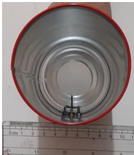
Gambar 11 Realisasi cantenna Besar (A) Tampak Depan (B) Tampak Samping
