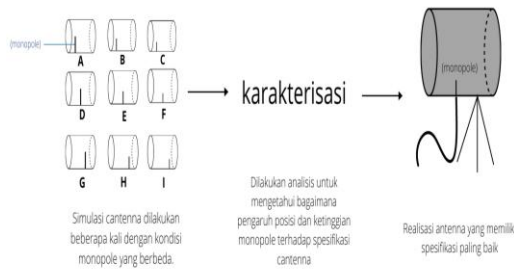
Gambar 2 Ilustrasi Sistem Uji Cantenna
