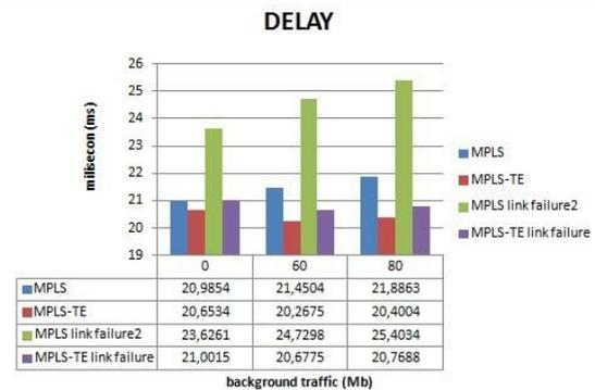
Dari hasil pengukuran terlihat pada grafik masing – masing skenario delay MPLS-TE lebih baik dibanding delay MPLS. Hal mendasar ini disebabkan karena jalur lewatnya paket sudah diatur untuk MPLS-TE, artinya pada kondisi tersebut, utilitas jaringan MPLS-TE sudah diatur agar saat terjadi antrian paket masih bisa diatasi dengan baik.
