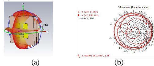
Gambar 8 Grafik Hasil Simulasi (a) Polarisasi (b) Impedansi
