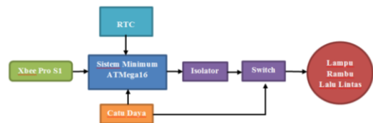
Gambar 3.1 Diagram Blok Hardware Sistem Pengatur Lalu Lintas
