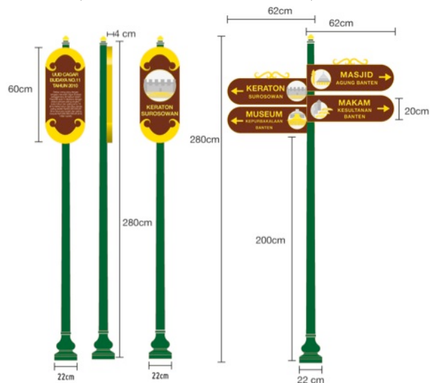
Gambar 4.21 Hasil Perancangan Identified Signs Situs, Regulatory Signs Situs dan Wayfinding (Sumber : Dokumentasi Penulis)
