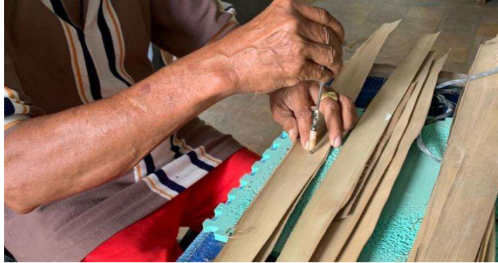
Gambar I - 5. Proses Pelubangan Sumber. Observasi Langsung
