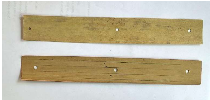
Gambar I - 7. Kegagalan Produksi Pada Proses Pelubangan
