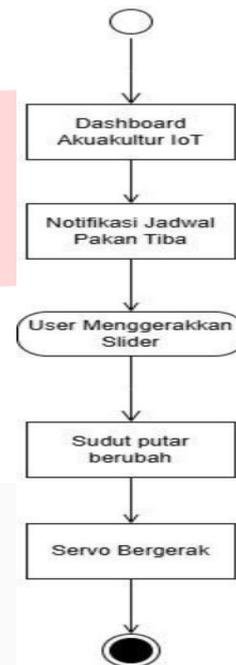
Gambar di atas menunjukkan diagram aktivitas yang merepresentasikan proses bisnis saat user menggerakkan slider pada dashboard untuk mengaktifkan servo motor sebagai aktuatur pemberi pakan ikan dalam sistem Akuakultur Berbasis IoT.
