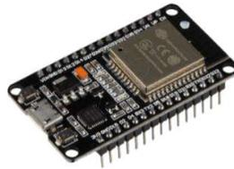
Gambar 4.4 Mikrokontroler ESP32
