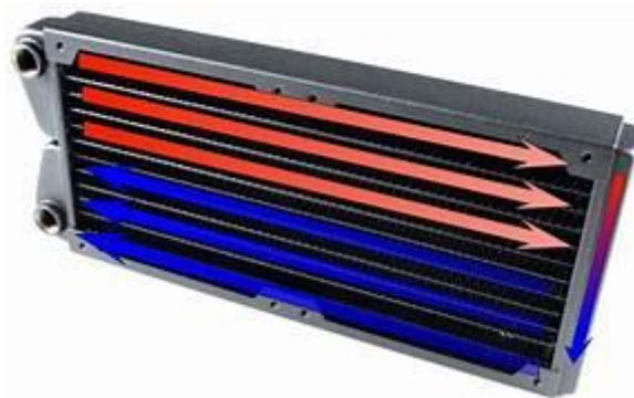
Gambar 1.2.1 Cara Kerja Radiator
