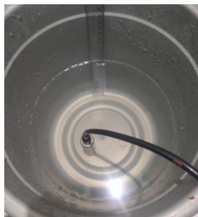
GAMBAR 12 (Pengujian Kalibrasi Sensor Submersible Water Level terhadap Alat Ukur Penggaris)
