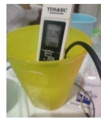
GAMBAR 4 (Pengujian Kalibrasi Sensor TDS terhadap TDS Meter)
