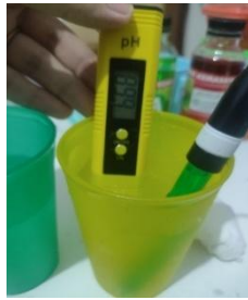
GAMBAR 8 (Pengujian Kalibrasi Sensor pH terhadap pH Meter)
