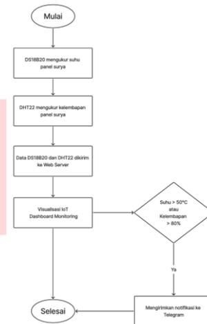
Gambar 2 Monitoring Suhu dan Kelembapan Panel Surya
