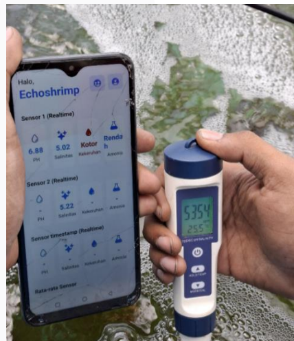
GAMBAR 9 (PENGUJIAN KEAKURATAN SENSOR SALINITAS)
