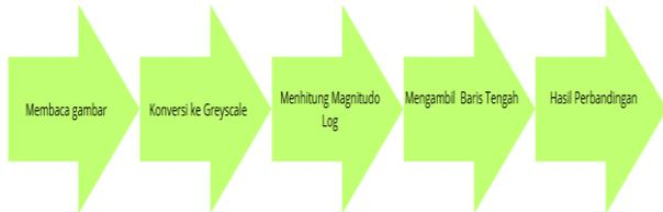
Gambar 3.2 Blok diagram pengujian HFR
