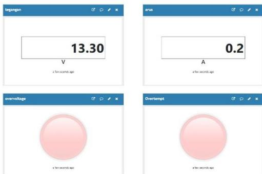
Gambar 7 Visualisasi numerik dan indikator overvoltage dan overtemperature
