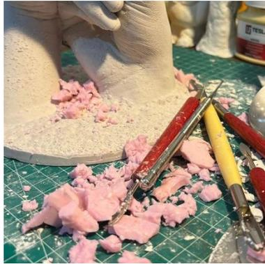
Gambar 16 Pengelupasan molding
