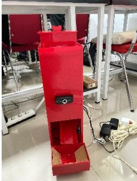
GAMBAR 11. PROTOTIPE SISTEM PAKAN KUCING OTOMATIS
