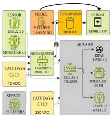
Gambar di atas menyajikan blok diagram dari solusi sistem yang diusulkan dan telah terpilih untuk diimplementasikan. Sistem ini memiliki beberapa komponen masukan, yaitu sensor DHT22 dan sensor soil moisture hygrometer, yang berfungsi untuk mengukur kondisi lingkungan pada area budidaya maggot. Selain itu, sistem juga dilengkapi dengan Pi Camera yang
