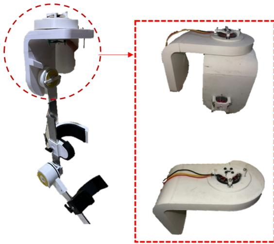
Fig. 8. Eksoskeleton Joint Bahu
