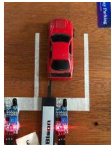
Gambar 3. 2 Sistem kendaraan terdeteksi
