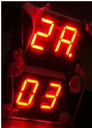
Gambar 3. 6 Gambar display penanda parkir slot tersedia & terdekat
