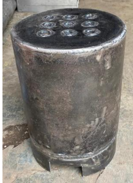
Gambar 3.6 boiler setelah pengelasan
