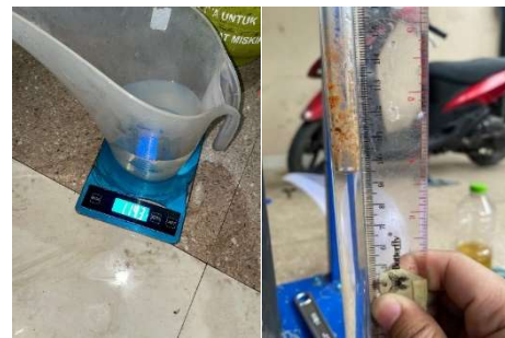
Gambar 4. 13 Proses kalibrasi gelas penduga
