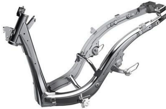
Gambar 1.3. Rangka eSAF PT Astra Honda Motor
