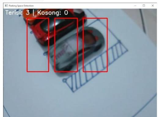
Gambar 21. Hasil pengujian sudut rotasi 45 derajat
