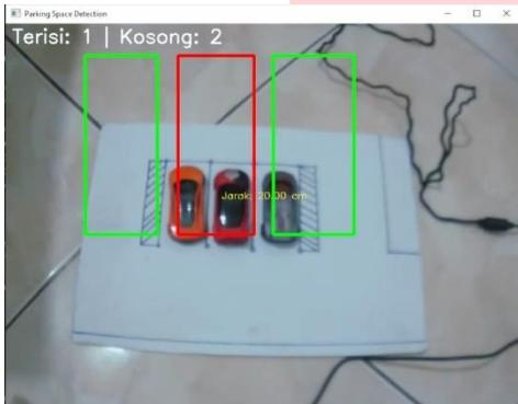
Gambar 18. Hasil pengujian jarak ketinggian 20 cm
