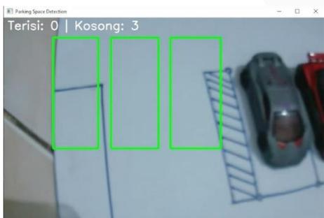
Gambar 24. Hasil pengujian sudut rotasi 150 derajat
