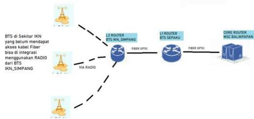
Gambar 6. Topologi Router BTS Sepaku menuju BTS IKN\_Simpang
