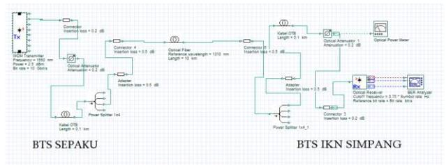
Gambar 9. Simulasi perancangan untuk XGPON disisi downlink
