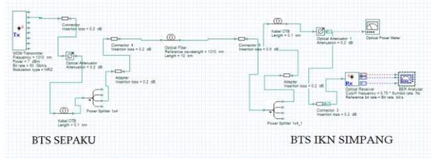
Gambar 10. Simulasi perancangan untuk NGPON disisi downlink
