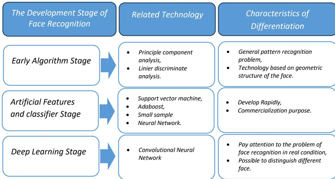
**Gambar 1.3** Tahapan pengembangan teknologi *Face Recognition* [19]
