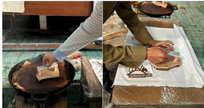
Gambar VII Proses Pengecapan Pada Lembaran Kain
