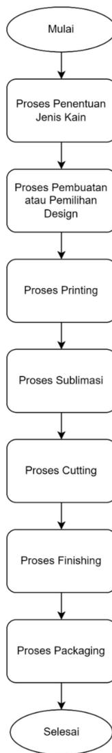
Gambar I. 2 *Flow Process* Produksi Hijab *Printing*
