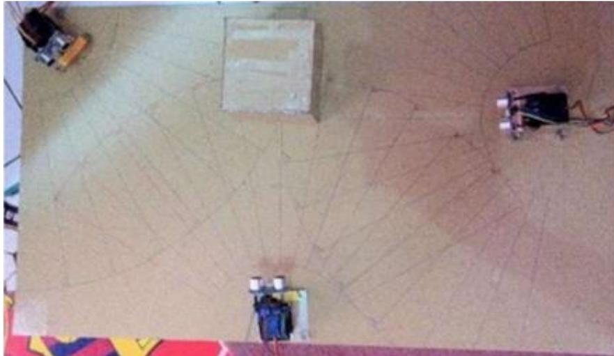
**Gambar 1.2 Simulasi pengujian 3 buah sensor terhadap objek kubus [9].**
