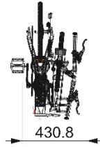
Gambar 14 .Gambar teknik sepeda saat dilipat tampak atas
