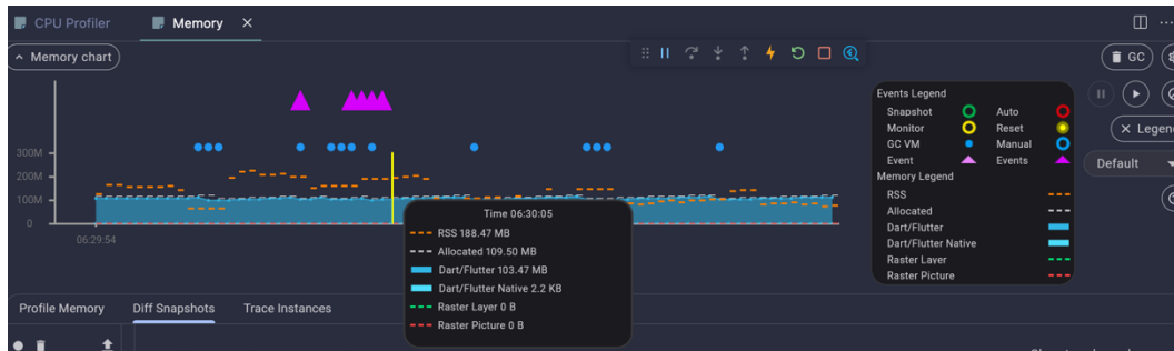
Gambar 4. 9 Memory Profiler yang mengukur Penggunaan RAM pada Ponsel
