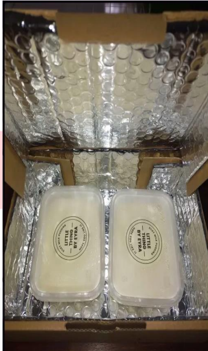
Gambar 6 Uji Coba Insulasi Kemasan sumber: dokumen penulis
