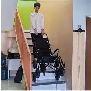
Kursi roda diuji pada tangga Kost Pondok Sae dengan ketinggian anak tangga 21,5 cm dengan lebar 30 cm tanpa beban atau pengguna. Berdasarkan hasil pengujian, kursi roda mampu melewati akses anak tangga. Pengujian kursi roda dengan beban atau pengguna pada anak tangga Kost Pondok Sae dengan ketinggian 21,5 cm dan lebar 30 cm tidak memungkinkan dikarenakan lebar pijakan yang kurang luas dan ketinggian anak tangga yang melebihi standar.
