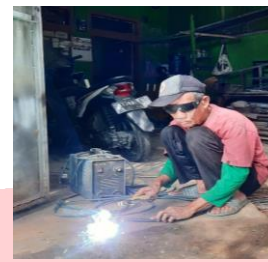
GAMBAR 3. Kacamata Eksisting yang digunakan operator las
