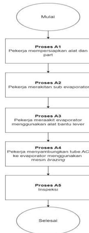
Gambar 1 Alur Proses Produksi Produk AC Mobil
