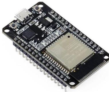
Gambar II.4 Mikrokontroler ESP32 Modul WiFi
