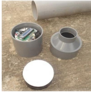
Gambar 1. 4 Prototipe alat ukur ketinggian air laut menggunakan sensor inframerah berbasis mikrokontroler ATmega328
