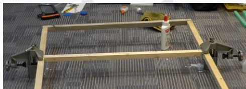
Gambar 4. Proses perekatan frame kayu Sumber: Penulis, 2024
