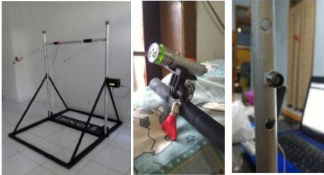
Gambar 1.2 Tes Chin-up Berbasis Arduino Uno dan Sensor Laser Infrared
