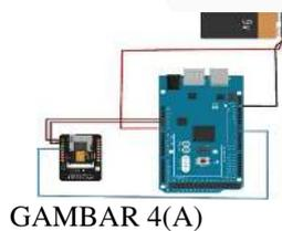
Skematik ini menunjukkan sebuah sistem yang terdiri dari sebuah baterai 9V sebagai sumber daya, Arduino Mega 2560 sebagai mikrokontroler, dan ESP32-CAM sebagai modul kamera. Arduino berfungsi sebagai otak sistem yang mengontrol ESP32-CAM. ESP32-CAM akan menangkap gambar sesuai dengan perintah yang diberikan oleh Arduino Mega 2560. Data gambar yang diambil oleh ESP32-cam akan di upload ke Firebase.
