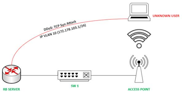
Gambar 4.6 Skenario Penyerangan DDoS (TCP Syn Attack)
