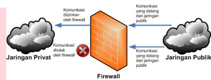
Gambar 2.7 Skema Firewall dalam Jaringan [17]
