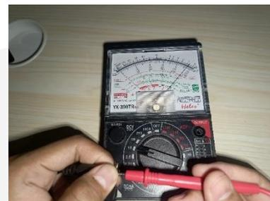
Gambar 14 Pengujian output tegangan adaptor
