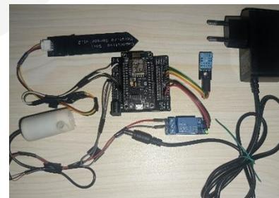
Gambar 11 Implementasi seluruh sistem dengan ESP8266
