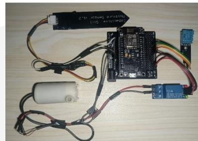
Gambar 10 Implementasi rangkaian ESP8266 dengan komponen
