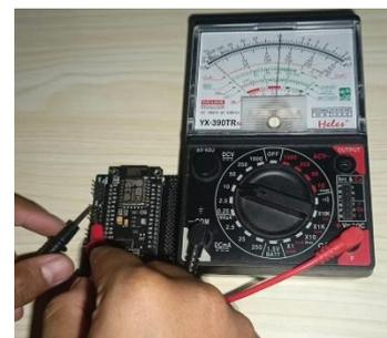
Gambar 15 Pengujian ground dan vcc pada board expansion esp8266
