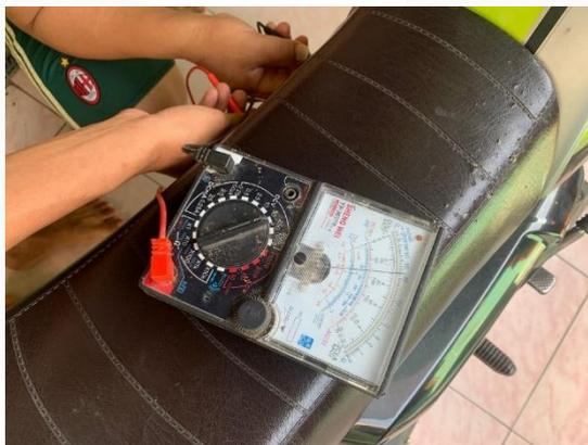
Gambar 10 Pengukuran Pada Relay 1
