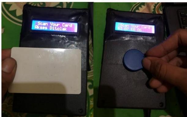
Gambar 4. 1 Pengujian menggunakan e-ktip dan tag biru rfid
