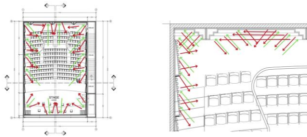
Gambar 18 Skema pemantulan suara pada dinding
