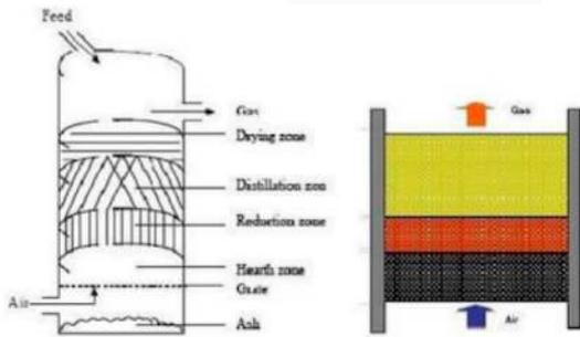
GAMBAR 1 (Skema Tungku Gasifikasi Updraft)
