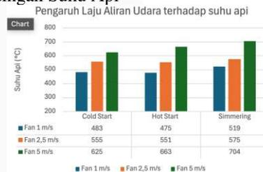
GAMBAR 6 (Grafik Pengaruh Laju Aliran Udara Terhadap Suhu Api)
