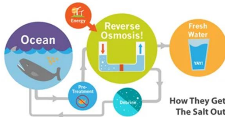
Gambar 4. Proses Desalinasi RO
