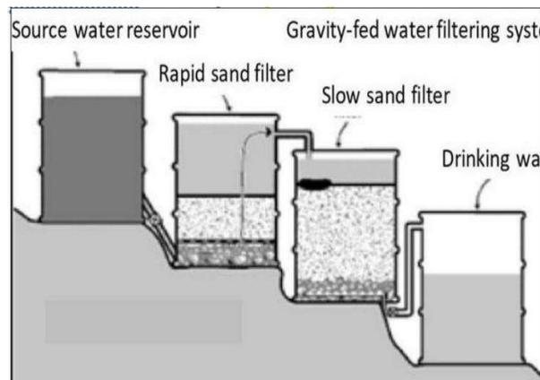
Gambar 1.3. 4 Sistem Penjernihan Menggunakan Sistem Gravity-Fed Filtering [17]
