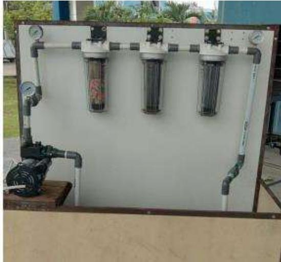
Gambar 1.3. 3 Skema Sistem Penjernihan Air Portable Menggunakan Filter Air [15]
