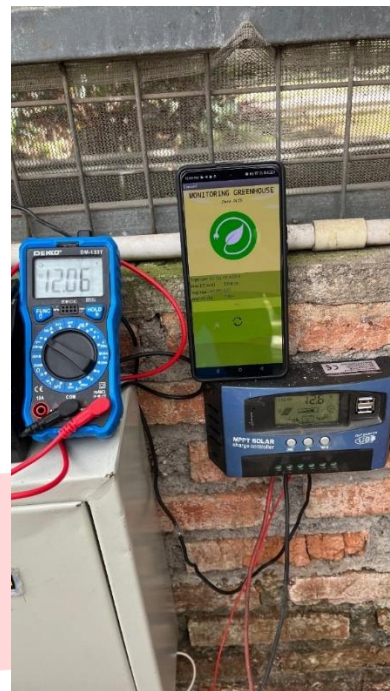
GAMBAR 8(C). Pengujian Sensor INA219
