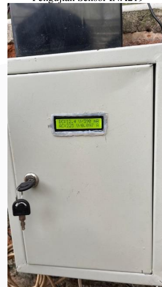
GAMBAR 9(C). Tampilan Sensor INA219 pada LCD
