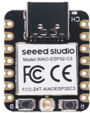
GAMBAR 1 Mikrokontroler Xiao ESP32-C3
