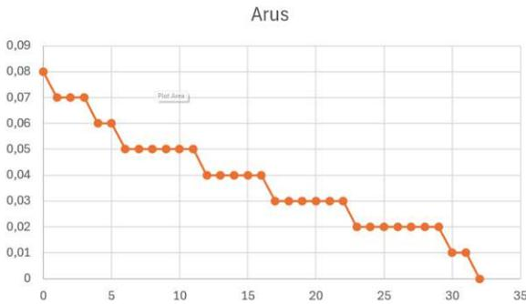
GAMBAR 14: Grafik Arus Hasil Monitoring Pengosongan Baterai
