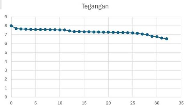
GAMBAR 13: Grafik Tegangan Hasil Monitoring Pengosongan Baterai
